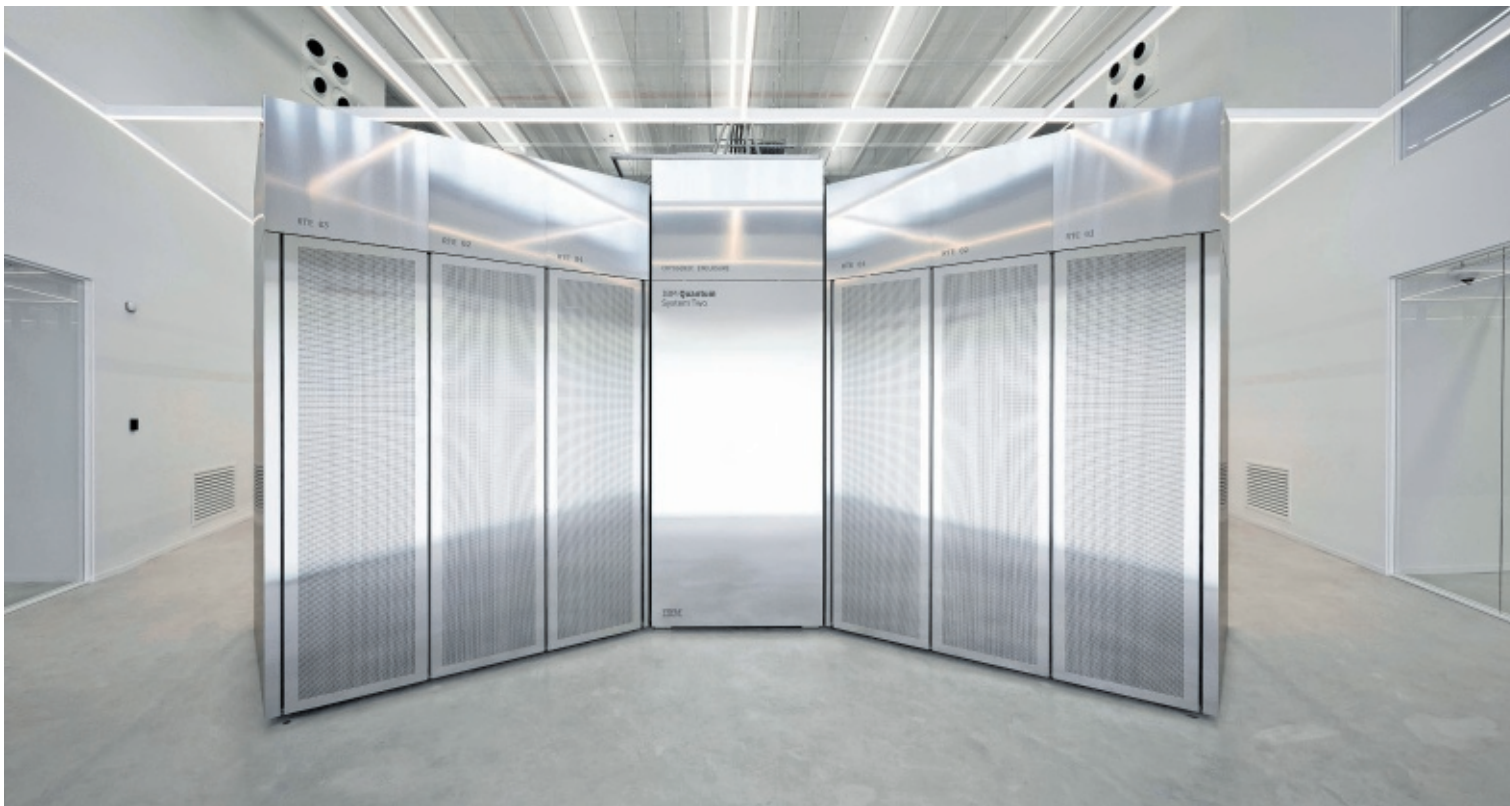
El sistema opera a 273 grados bajo cero, porque sus 156 cúbits son extremadamente frágiles; las medidas de seguridad son extremas. IBM
