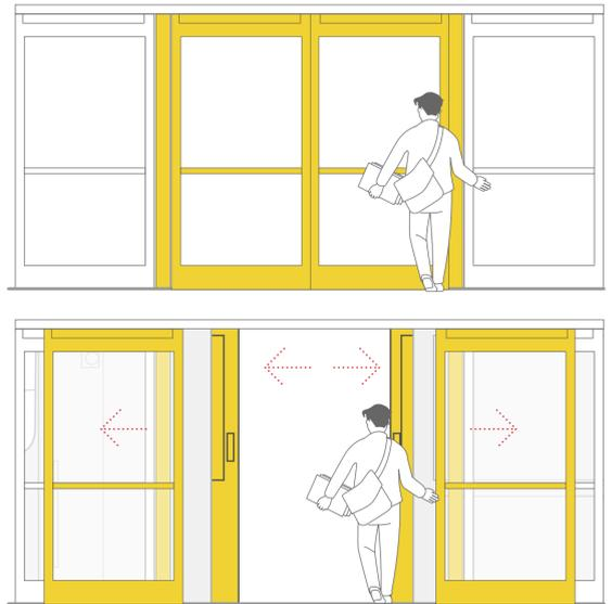
Consiste en la colocación de unas mamparas de cristal a lo largo de todo el andén que permiten el acceso a los trenes a través de unas puertas que se abren de forma sincronizada con las del tren.
