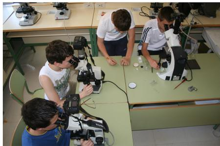
Generalmente hay que reajustar el enfoque del microscopio cuando observamos desde el visor de la cámara para obtener una imagen nítida.
