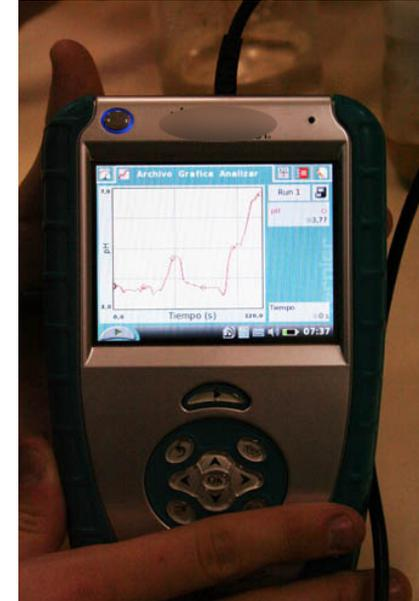
Mediante una estación de análisis portátil hemos podido tomar datos de algunos parámetros físicos y químicos del agua ( pH, conductividad,  $T^a$ , presencia de nitratos y de iones de Calcio y Demanda Biológica de Oxígeno) en más de 40 localidades del norte de España.
