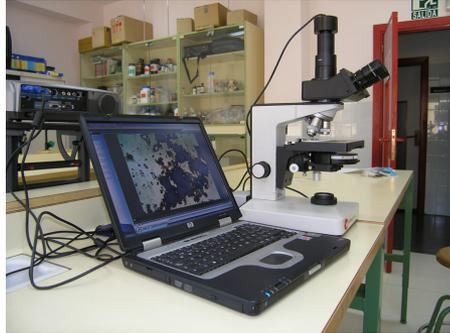
La mayoría de los microscopios que utilizamos tienen un cabezal trinocular y llevan adaptado en el tubo fotográfico una cámara para digitalizar imágenes fijas o en movimiento.
